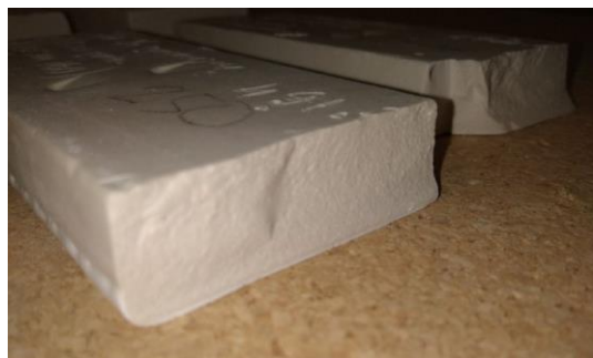
Рисунок 2.30 – Зразки наномодифікованої кераміки після дослідження на міцність
